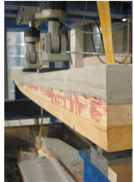
Holz-Beton-Verbund-Element im Biegeversuch
