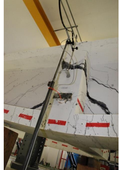
Legende: Bauteilversuch indirekte Lagerung.
